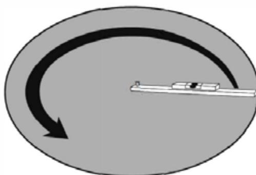
BITTE BEACHTEN Unebenheiten und Löcher nicht füllen, sondern erhöhtes und überstehendes Material abtragen und eine ebene Fläche herstellen.
