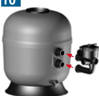
Mettre en place la vanne multivoies : placer d'abord la traversée basse puis la traversée haute. Serrer les écrous modérément.
