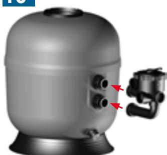
Montieren Sie das Mehrwegeventil: Bringen Sie zuerst die untere, anschließend die obere Wanddurchführung an.
