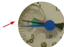
On observe, après un certain temps de filtration une diminution du débit au refoulement. Cette diminution du débit est causée par l'enrassement progressif du filtre ou du préfiltre de pompe.
