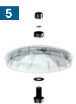
Montieren Sie das Entlüftungsventil auf den Deckel.
