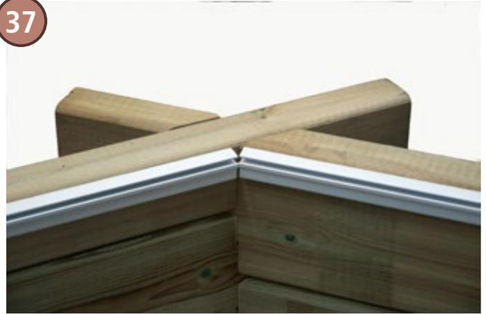
Für jede Seite des Pools ist zum einen ein Profil von 1,18 m Länge vorgesehen sowie ein zusätzliches Stück, das entsprechend gekürzt werden muss (siehe Tabelle). Konsultieren Sie nachstehende Tabelle und bereiten Sie die 8 zusätzlichen Stücke vor. Bevor Sie die Klemmprofile zuschneiden, überprüfen Sie bitte genau, ob die Gesamtlänge des Profils der Länge der Wand abzüglich 10 cm entspricht. Achten Sie auf gerade und saubere Schnittflächen. Glätten Sie die Schnittflächen mit Hilfe der Feile.
