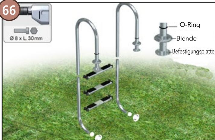
Bauen Sie die einzelnen Komponenten der Leiter anhand beiliegender Montageanleitung zusammen. Vergessen Sie bei der Montage der Griffbögen die beiden O-Ringe nicht, da diese die dekorativen Verankerungsblenden an Ort und Stelle halten sollen.
