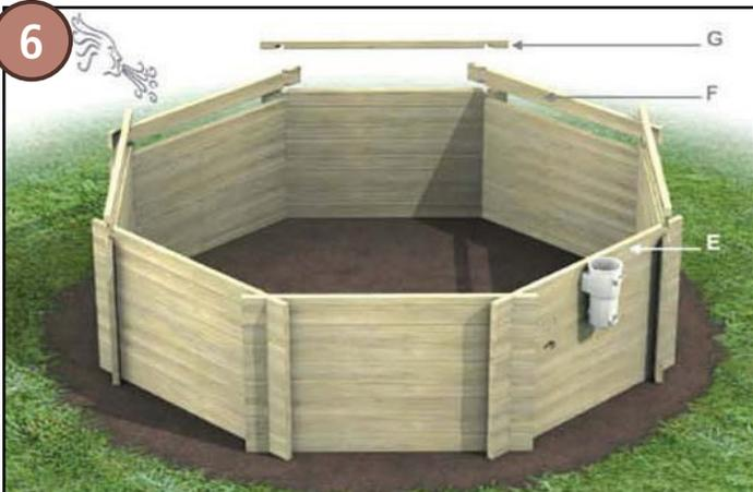
Fügen Sie nun die obere für den Skimmer vorgesehene Bohle (Typ E) in die soeben montierte Bohle (Typ D) und montieren Sie entlang der Poolwand 3 Bohlen des Typs F und 4 halbe Bohlen des Typs G wie in der Abbildung gezeigt.
