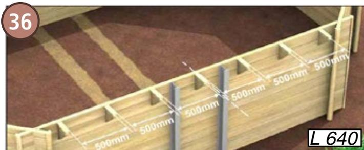
Montieren Sie die Holzkeile an den Längsseiten wie dargestellt.
