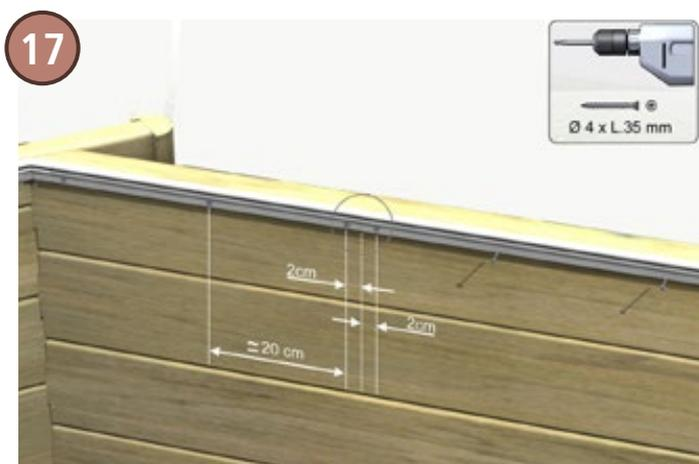
Befestigen Sie das Klemmprofil zunächst mit 2 Schrauben, die 2 cm von jedem Ende entfernt sind. Fügen Sie danach zur endgültigen Befestigung des Klemmprofils Schrauben in Abständen von 20 cm ein. Verwenden Sie dazu Schrauben Ø 4 x 35 (Beutel D).
