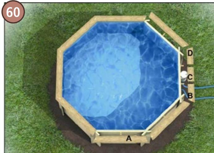
In der Abbildung sind die einzelnen Bestandteile des Handlaufs und deren Position dargestellt. Arrangieren Sie die Teile der Abbildung entsprechend auf den Holzkeilen. Achten Sie darauf, dass die Teile um den gesamten Pool herum korrekt und geradlinig positioniert sind. Korrigieren Sie, falls nötig, deren Position und achten Sie darauf, dass sie sich vor dem Festschrauben nicht mehr verschieben können.
