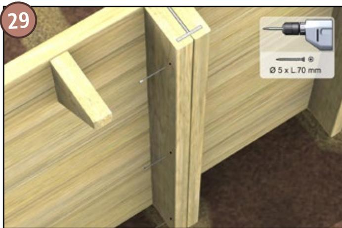
Schrauben Sie die Metallpfosten (vorgebohrt) mit Hilfe von 6 x 30 mm Schrauben aus Pack S von außen an den Holzwänden fest. Achten Sie darauf, dass die Pfosten exakt vertikal verlaufen. Positionieren Sie an beiden Seiten der Pfosten ein Abschlussprofil (Q) und befestigen Sie es mit Hilfe von drei 5 x 70 Schrauben (Pack S) wie abgebildet.
