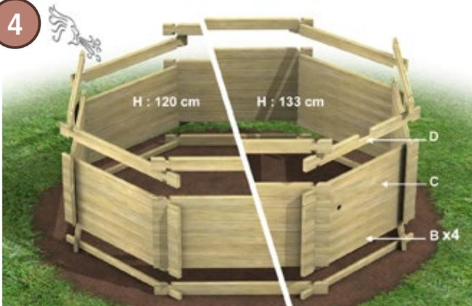
Stecken Sie die übrigen Bohlen (Typ B) zusammen; achten Sie darauf, dass die für die Einlaufdüse vorgesehene Bohle (Typ C) sowie die untere Skimmer-Bohle (Typ D) richtig positioniert ist. Die für die Einlaufdüse vorgesehene Bohle muss oberhalb von 4 Bohlen des Typs B + 1 Bohle des Typs A angesiedelt sein. Positionieren Sie die Bohle des Typs D an der gleichen Seite in der letzten in diesem Schritt gezeigten Reihe.
