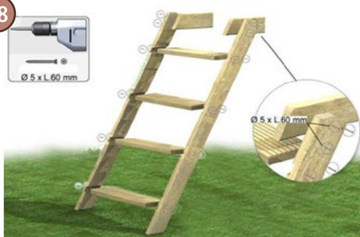
Die seitlichen Wangen sowie die Stufen der Holzleiter finden Sie im Holz-Set. Verwenden Sie zum Zusammenbau der Holzleiter die mitgelieferten Edelstahl-Schrauben (Set K). Es empfiehlt sich, die einzelnen Elemente vorzubohren (4 mm Bohreinsatz) und die Bohrlöcher abzufräsen, damit das Holz nicht reißt und keine Holzsplitter entstehen.
