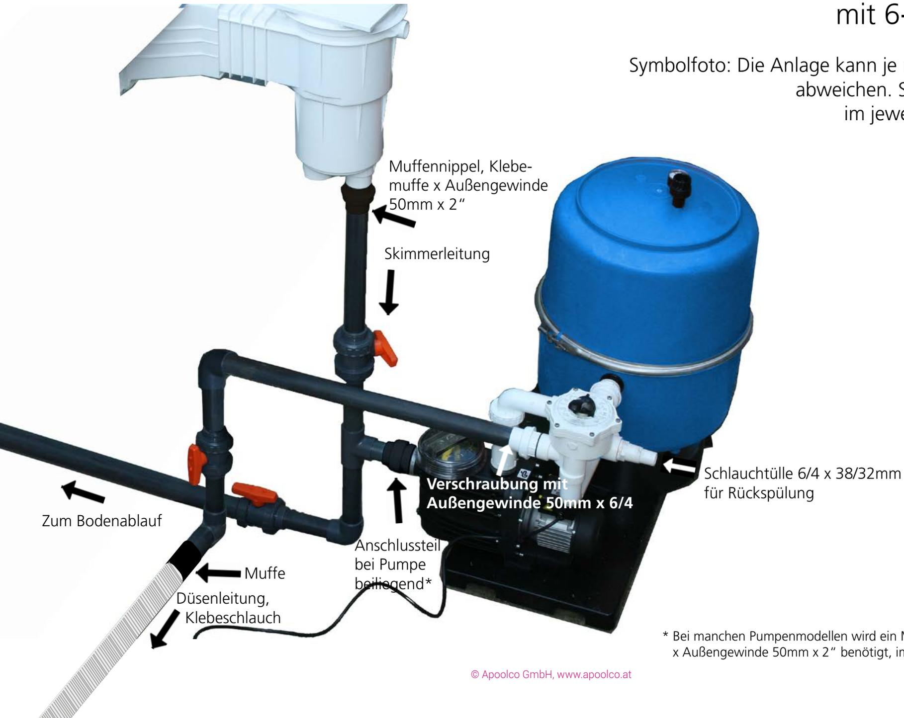
\* Bei manchen Pumpenmodellen wird ein Muffennippel, Klebemuffe x Außengewinde 50mm x 2" benötigt, im Lieferumfang enthalten.
