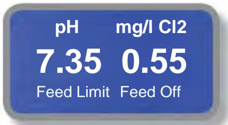
Nach Ablauf der max. Dosierzeit ohne Erreichen des Sollwertes erscheint die Meldung „Feed Limit“ unter dem betreffenden Messparameter.
