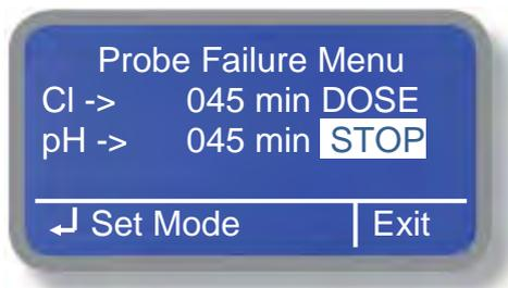
Drücken Sie im Hauptmenü das Klick-Wheel auf der Position „Probe Failure“, um das Untermenü zu öffnen.
